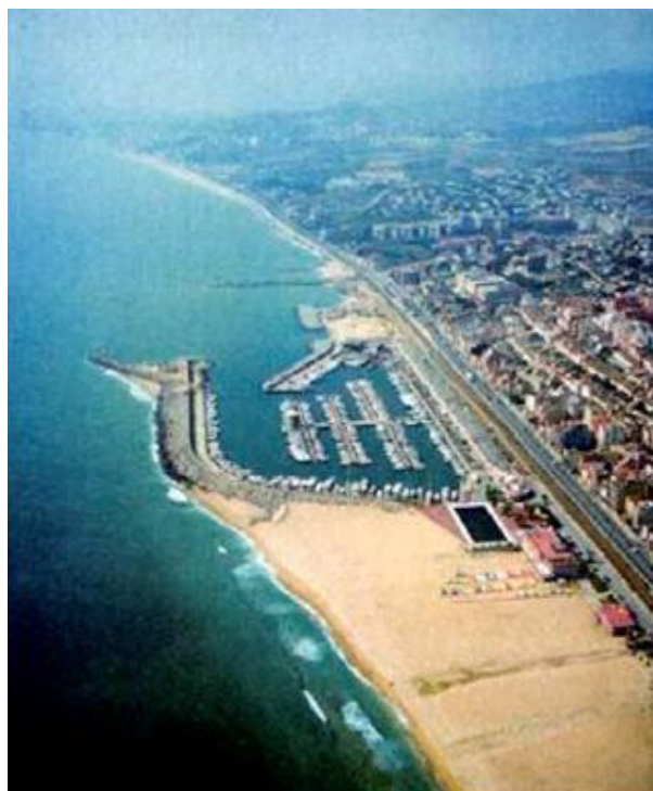
Figura 6: Efectos en el transporte litoral debidos a un puerto deportivo
